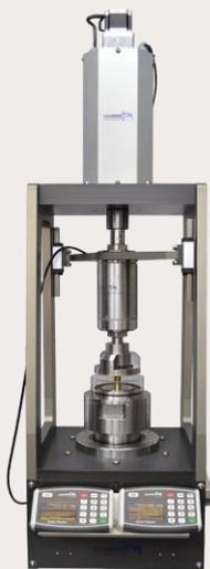
**概述:** GDSRSA 是一个现代化的、紧凑的、桌面化的环剪系统，允许完全自动化的试验。该 GDSRSA 允许进行扭转环剪试验。在排水条件下，通过步进电机连续施加旋转剪切作用力直到获得恒定的残余剪切应力。在试验过程中，试样的横截面区域的剪切面不变。GDS 的环状剪切仪通过 GDS 力作动器施加固结应力，通过计算机（用 USB 连接）来进行控制和数据采集，外置的荷载传感器直接测量施加到样品上的轴向和剪切应力。
